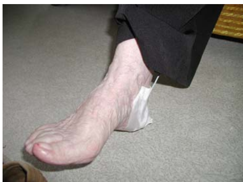
Kuva 5. Alustaan kohdistuvaa painetta mitattiin asukkaan kantapäihin kiinnitetyillä paineantureilla.
